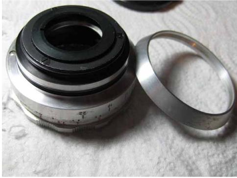
Die drei Schrauben werden abgeschraubt. Der Ring wird vorsichtig abgenommen. Darunter sind die Geradführungen mit kleinen Federn. Den Ring mit der einen Hand umfassen und den Ring vorsichtig anheben. Die Federn und die Bolzen in denen die Federn stecken entfernen. (Pic 9; roter Pfeil: Schraube für Endanschlag; schwarzer Pfeil: Nut Geradführung; blauer Pfeil: Bolzen ohne Feder für Geradführung)
