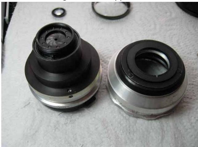
Achtung im Inneren ist ein loser Aluring mit einer Freidrehung an einer Seite. Die Ausdrehung ist kameraseitig. Bei der Wiedermontage darauf achten, dass die Nuten vom
