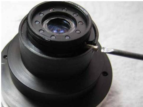
Ring mit der Beschriftung der Blendenzahl abheben(Pic 7).
