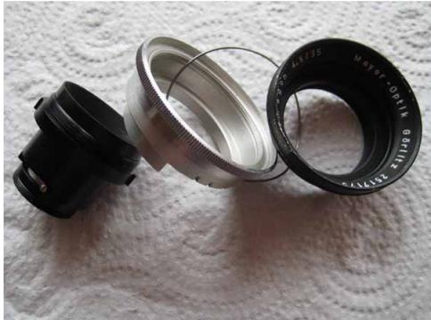
Jetzt wird der innere Kegel herausgedreht.
