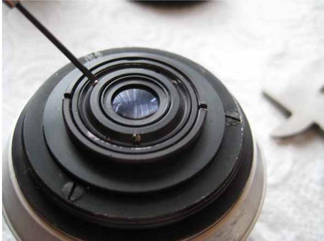
Wenn der Ring entfernt ist, kann die kameraseitige Linse entnommen werden. Durch den Kegel der Linse ist ein Verwechseln der Richtung beim Wiedereinbau nicht möglich.
