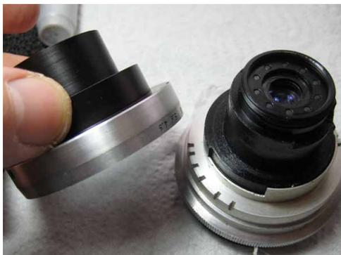
Die Gruppe Entfernungseinstellung wird weiter zerlegt, indem der kegliche Aluring abgeschraubt wird (Pic 8).
