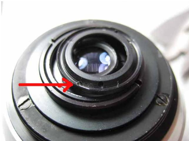
Die drei Madenschrauben zentrieren die Linse. (Pic 2) Nicht lösen.
